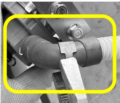
Befestigen Sie den weißen Abwasserschlauch mit dem grauen 90° Winkel am Abwasserauslass der Pumpe und fixieren Sie das Ende mit der mitgelieferten Schelle (Schlauch und Klemme sind im Lieferumfang der Maschine enthalten).
