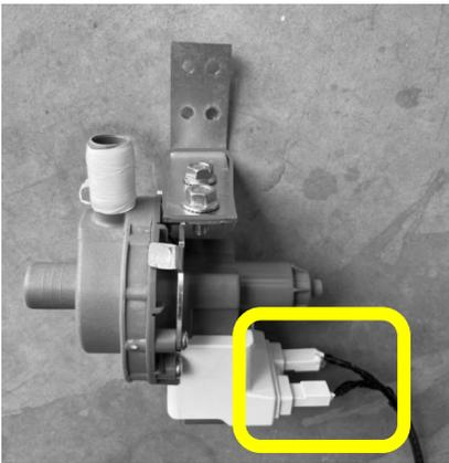
Stecken Sie das Verbindungskabel auf die Anschluss-Pins der Pumpe. Achten Sie darauf, dass die Stecker vollständig auf die Pins geschoben werden.
