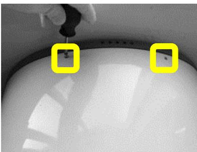
Sie müssen jeweils die 2 Schrauben von der Ober- und Unterseite des Gehäuses entfernen, um dieses abzunehmen.
