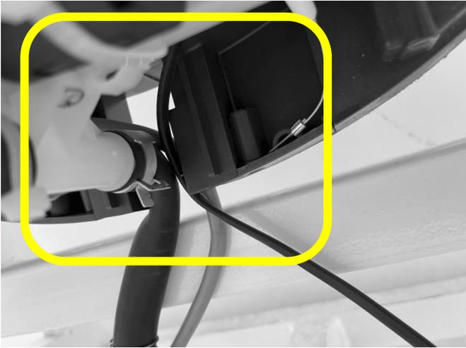
1. Fädeln Sie das Anschlusskabel durch die dafür vorgesehene Aussparung (Anschlussbereich unten, mittig) in die Maschine ein.
