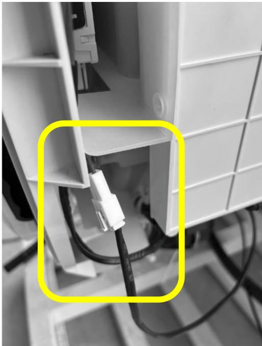
2. Stecken Sie den Anschlussstecker der Pumpe in die Anschlussbuchse der Maschine, zu finden im unteren rechten Bereich der Maschine. Eine Verwechslung ist nicht möglich, da in der Maschine nur eine Anschlussbuchse zur Verfügung steht.
