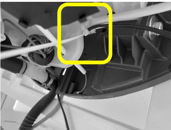
3. Fixieren Sie das Kabel zur Zugentlastung.
