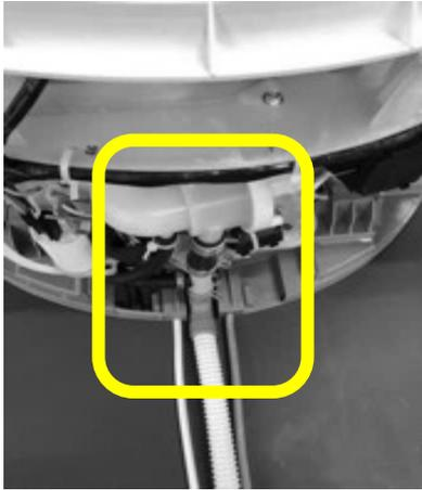
Befestigen Sie den schwarzen Verbindungsschlauch **mit dem 90° Winkel** am Abwasserauslass der Maschine und fixieren Sie das Ende mit der mitgelieferten Schelle.
